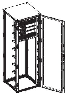
19-дюймовый вертикальный профиль, смонтированный непосредственно на профиле шкафа.
