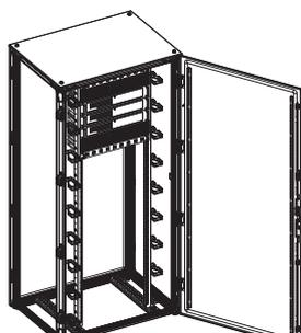
19-дюймовые вертикальные профили смонтированные на четырех универсальных поперечных элементах RZUT 4, 6, 8 (в зависимости от глубины шкафа) с держателями поперечных элементов RZ6P2.
