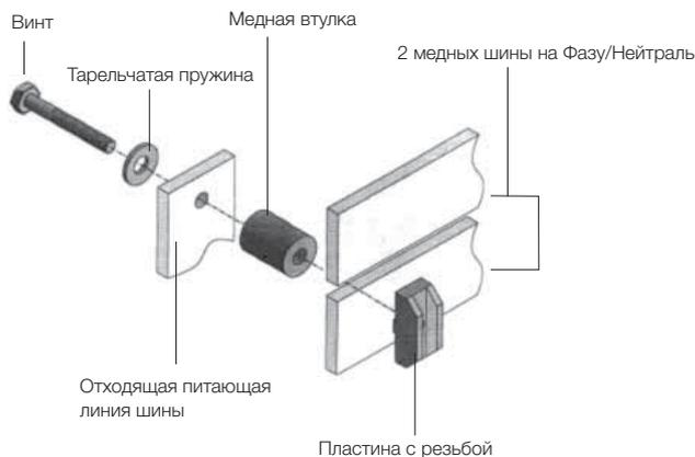
Система сборных шин состоит из двух вертикальных медных плоских шин, расположенных друг над другом. Шины отходящих питающих линий соединяются через медные втулки. Нет необходимости сгибать шины отходящих питающих линий благодаря расположению основных сборных шин с интервалами. Соединительные болты с шестигранной головкой, тарельчатые пружины и соединители с резьбой.
