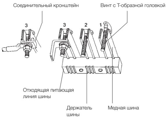
Выводы шины с кабелями или отходящими питающими линиями могут быть соединены с системой сборных шин в любой точке без пробивки отверстий. В случае применения питающих кабелей для обеспечения надежного контакта между шиной и кабельным наконечником должна быть установлена соединительная скоба. Модификация и изменение расположения отходящей питающей линии может быть произведена без внесения изменений в систему сборных шин.
