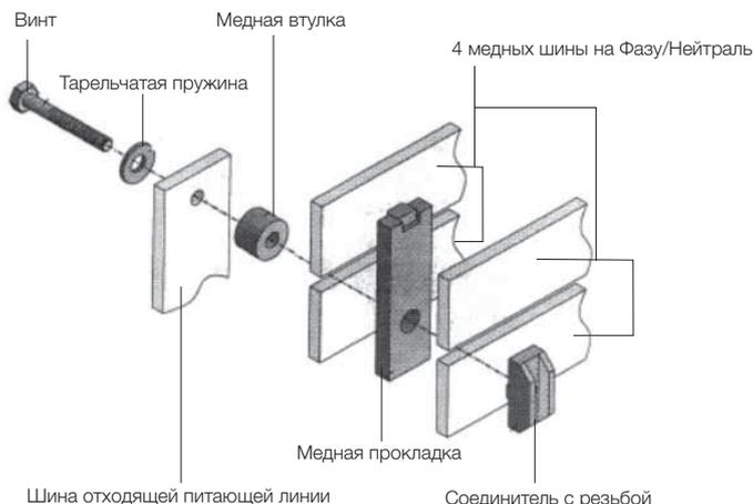
Система сборных шин состоит из четырех вертикальных/параллельных медных плоских шин, расположенных друг над другом. Шины отходящих питающих линий соединяются через медные втулки. Нет необходимости сгибать шины отходящих питающих линий благодаря расположению основных сборных шин с интервалами. Соединительные болты с шестигранной головкой, тарельчатые пружины и соединители с резьбой.
