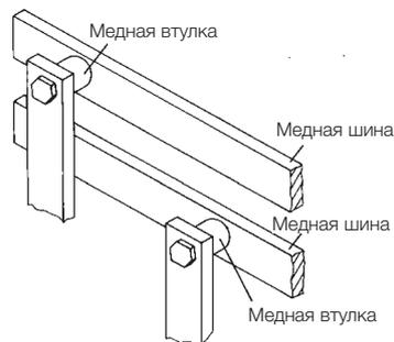
Шины отходящих линий с медной втулкой.
