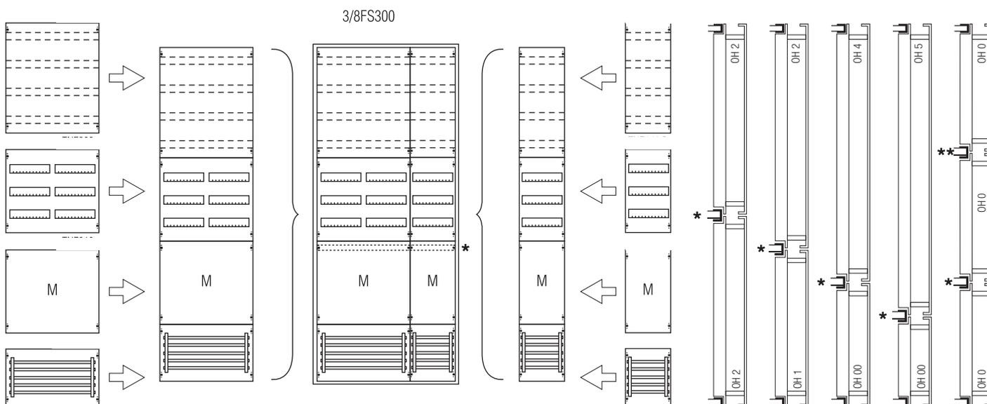
\*Положение центральной опорной перемычки регулируется вверх или вниз
