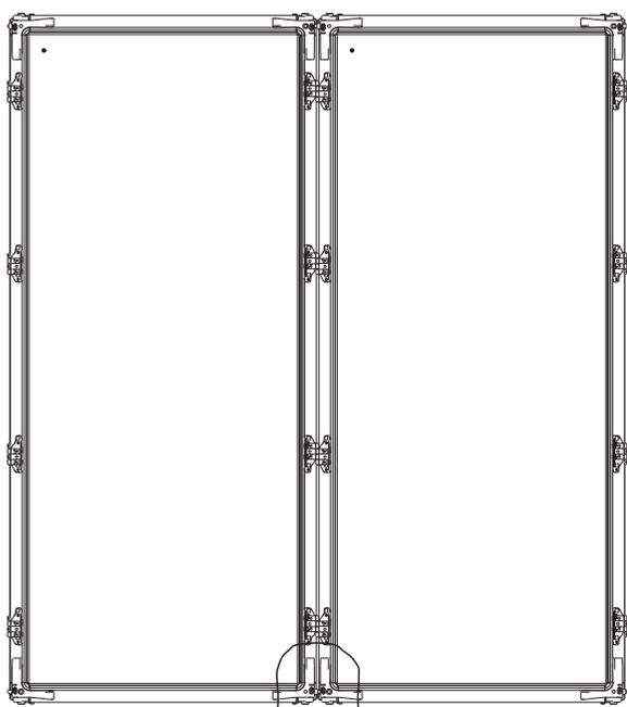
Ширина группы шкафов = сумма размеров по ширине отдельных шкафов + 10 мм для левых и правых боковых стенок (на каждую стенку по 5 мм)
