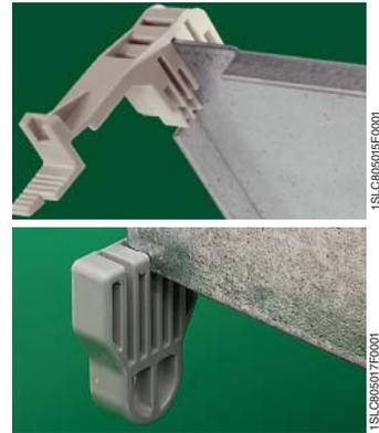
Специальные фитинги, входящие в стандартный комплект поставки монтажной платы, позволяют регулировать монтажную плату в семи положениях по глубине шкафа и трех положениях на фитинге.
