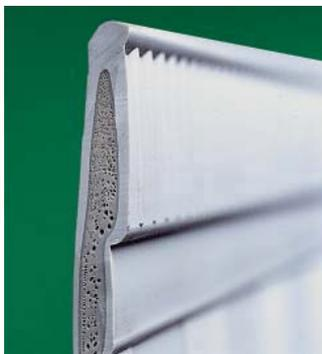
Универсальные шкафы Gemini IP66 изготавливаются с помощью метода двойной экструзии. Компания АББ первой стала применять этот метод при производстве электротехнического оборудования. Процесс изготовления изделия методом двойной экструзии заключается в формировании "сэндвича" из двух материалов - твердой наружной оболочки и пористой начинки. Такая структура изделия гарантирует высокую прочность (IK10) за счет толщины оболочки и небольшой вес без необходимости добавления упрочняющих ингредиентов.
