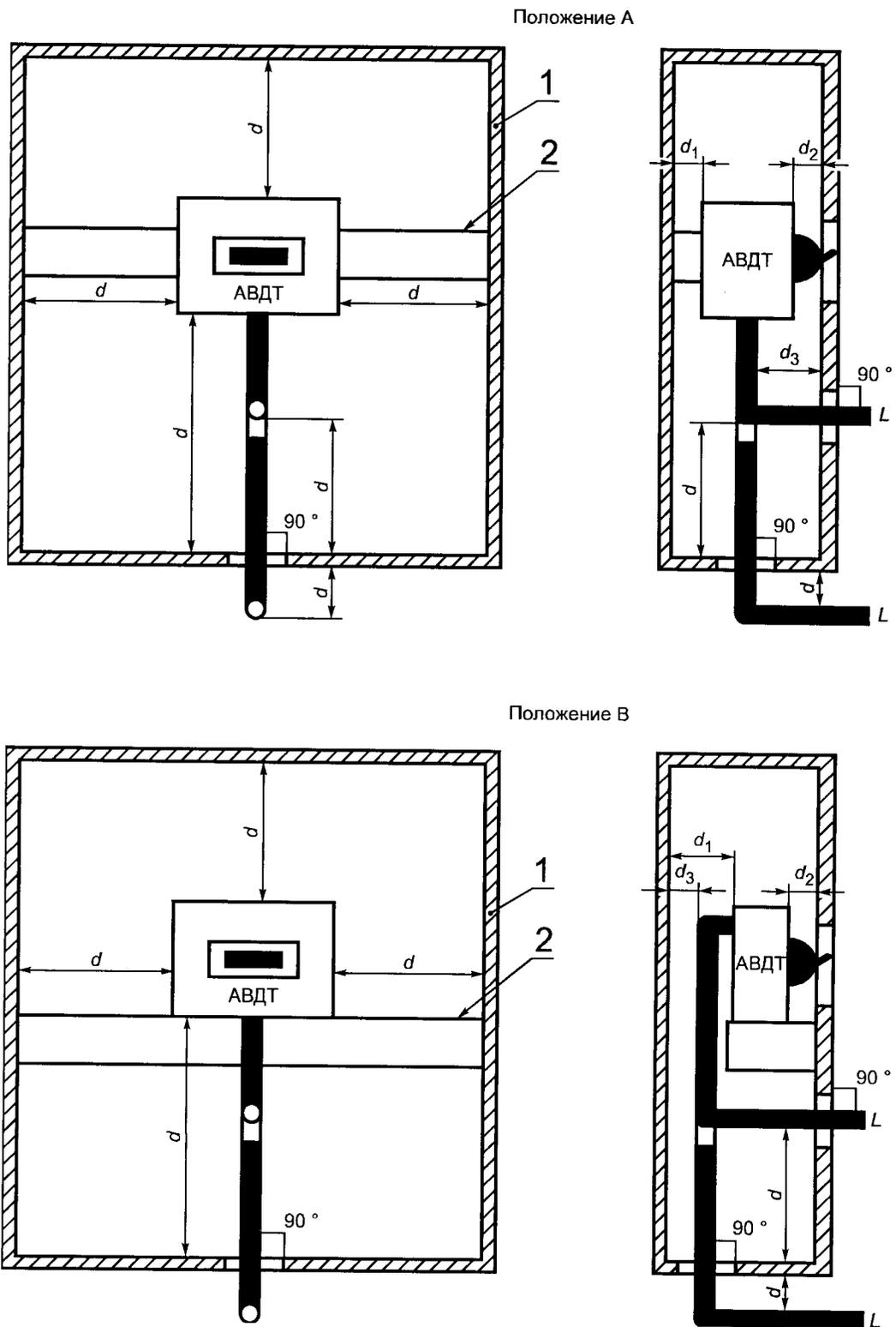
$l$  — металлическая оболочка; 2 — металлическая панель;  $L \leq 1$  м — максимальная длина кабеля между АВДТ и соединительным устройством;  $d$  — любой размер, но не менее 0,1 м;  $d_1$ ,  $d_2$  — согласно конструкции изготовителя;  $d_3$  — максимальное расстояние, допускаемое конструкцией
