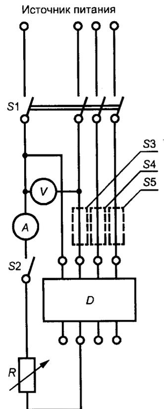
*V* — вольтметр; *A* — амперметр;
