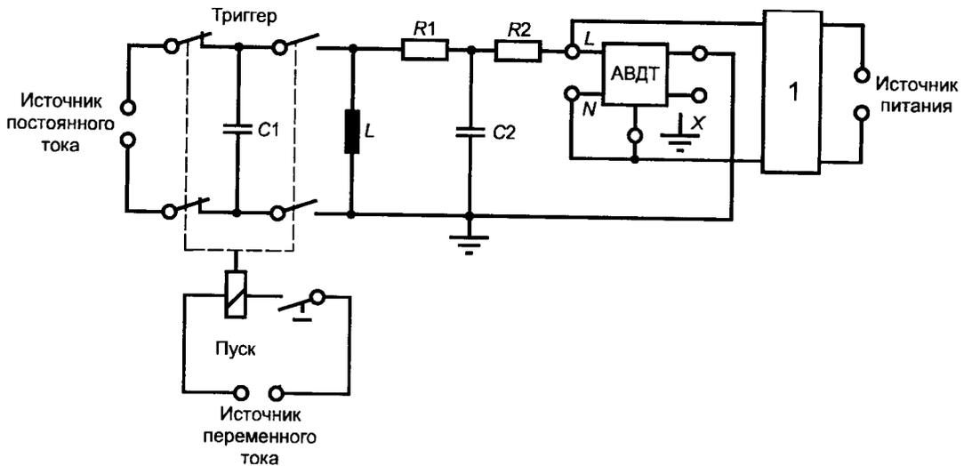
$I$  — фильтр;  $L = 5$  мкГн;  $R1 = R2 = 25$  Ом;  $C1 = 0,5$  мкФ;  $C2 = 5$  нФ;  $X$  — зажим заземления, если имеется, подсоединенный к нейтральному зажиму, если он маркирован, или, в отсутствие такой маркировки, к любому фазовому зажиму
