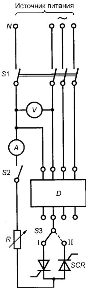
*D* — испытуемый АВДТ; *V* — вольтметр; *A* — амперметр (измерение действующего значения); *R* — регулируемый резистор; *S1* — многополюсный выключатель; *S2* — однополюсный выключатель; *S3* — выключатель на два направления; *SCR* — тиристоры
