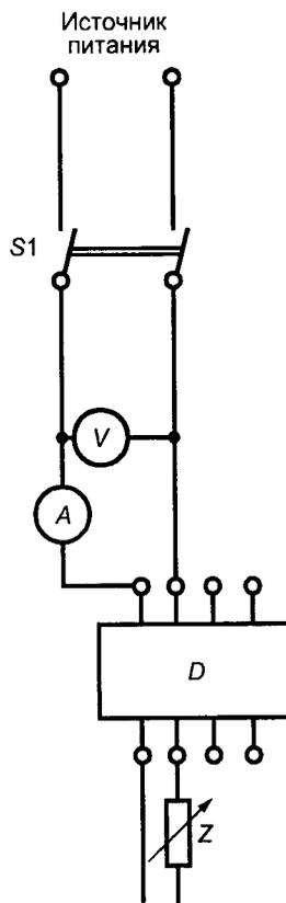
*A* — амперметр; *V* — вольтметр;
