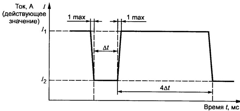
$I_1$  — ток уставки;  $I_2$  — испытательный ток провала;  $\Delta t$  — время провала
