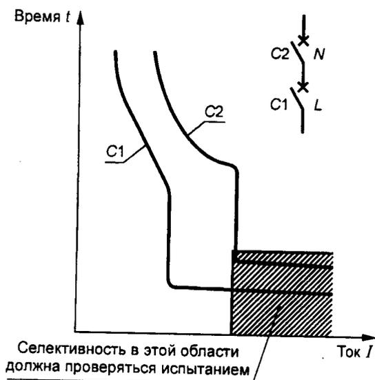
*C1* — токоограничивающий выключатель (*L*) (характеристика времени отключения);
