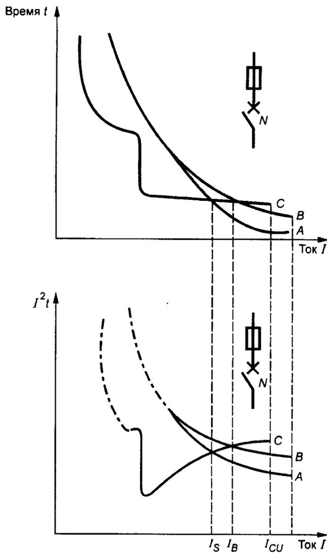
$I$  — ожидаемый ток короткого замыкания;  $I_{CU}$  — номинальная предельная наибольшая отключающая способность (4.3.5.2.1);  $I_s$  — предельный ток селективности (2.17.4);  $I_B$  — ток координации (2.17.6);  $A$  — преддуговая характеристика плавкого предохранителя;  $B$  — рабочая характеристика плавкого предохранителя;  $C$  — рабочая характеристика нетокоограничивающего выключателя ( $N$ ) (время отключения/ток и  $I^2t$ /ток)
