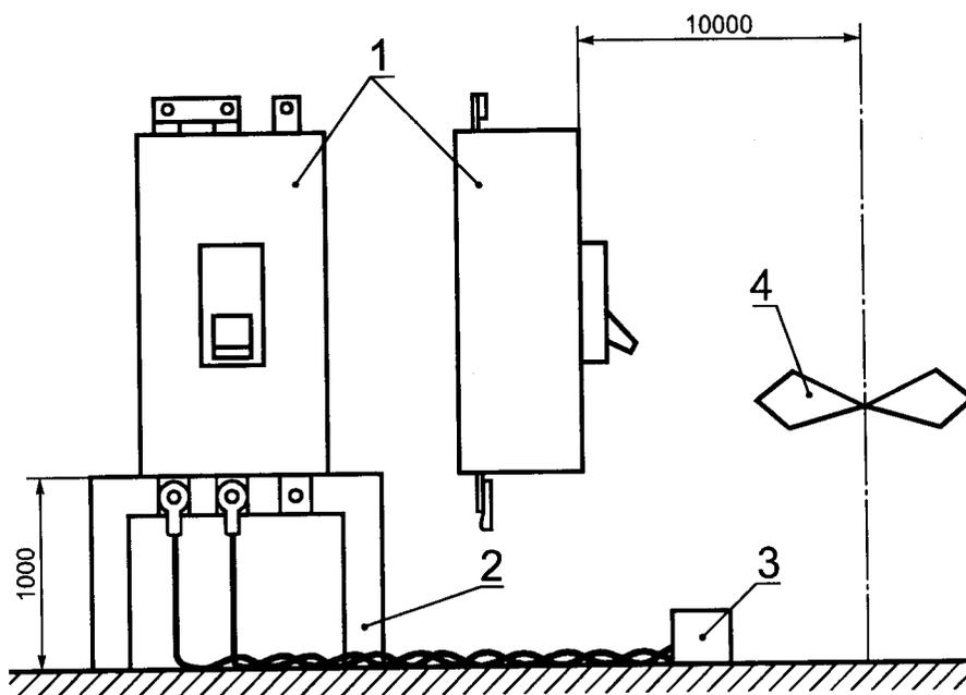
1 — испытуемый выключатель; 2 — изолирующая опора; 3 — источник питания; 4 — антенна
