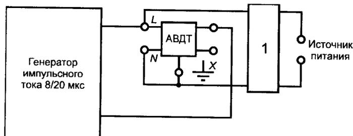
$I$  — фильтр;  $X$  — зажим заземления, если имеется, подсоединяемый к нейтральному зажиму, если он маркирован, или, в отсутствие такой маркировки, к любому фазовому зажиму
