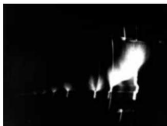
Фотография срабатывания стержневого молниеприемника (SRAT), полученная с высокоскоростной камеры.
