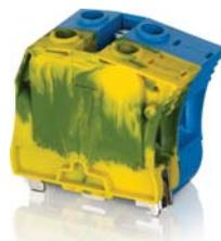
Клеммы защитного проводника с нейтралью (PEN) адаптированы для электросетей TNS и TNC-S за счет комбинации соединения проводов заземления и нейтрали (голубой). Для клемм 10 мм<sup>2</sup> и 16 мм<sup>2</sup> соединение выполняется с помощью безвинтовой перемычки. Для клемм 35 мм<sup>2</sup> соединение осуществляется в рамках заводской сборки.
