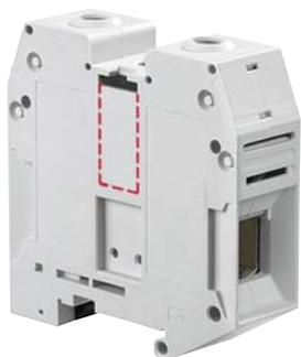
Плоскогубцами убрать перегородки на изолирующем корпусе клеммного соединения. Следить за тем, чтобы не удалить перегородки клемм с перемычками на обоих концах соединения для защиты и изолирования IP20, Nema1.
